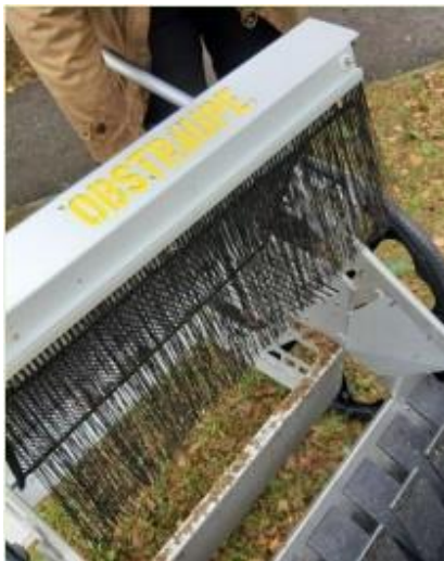
Der Laubrechen zwischen Kiste und Sammellappen ist hochklappbar und sollte zwischendurch gereinigt werden.
