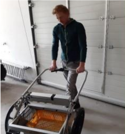
Arbeitshöhe des Griffs anpassen: locker baumelnde Arme sollen ihn fassen können
