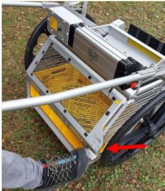
Sammelkiste einsetzen / tauschen: Hebel (Pfeil) mit dem Fuß betätigen, um Gitter zu öffnen
