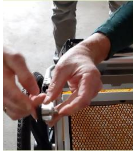
Griffhöhe einstellen: Schwarze Springschrauben in die richtige Lochung am Gelenk einstecken
