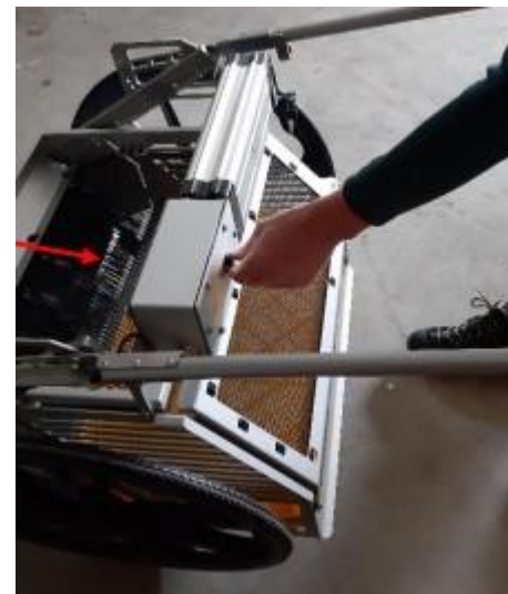
Regulation der Drehzahl: Drehen am Rädchen
