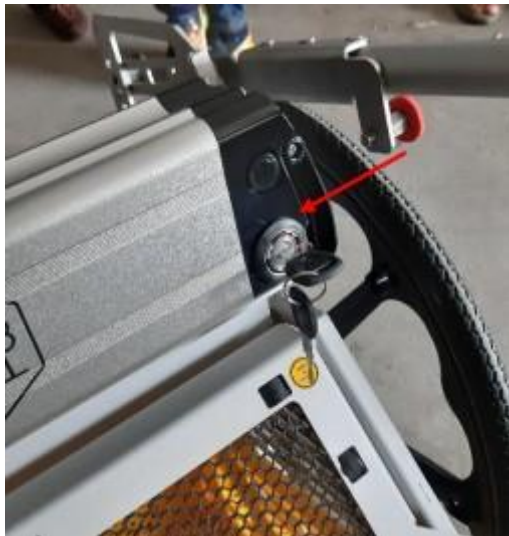
Inbetriebnahme: Schlüssel auf Position „on“
